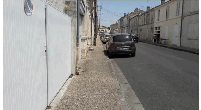
Cheminement réduit à moins de 1.20 ml par poteaux électriques, avec devers > à 2% sur 200 ml
