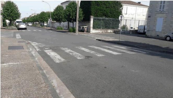
Carrefour avec 4 traversées sans abaissés conformes, ni bandes podotactiles
