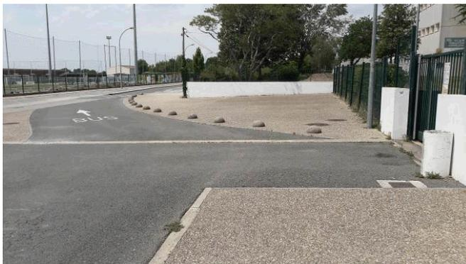
16 plots avec hauteur < à 50 cm : non conforme à l'abaque de détection
