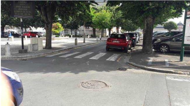
Traversée de voie sans bandes podotactiles ni abaissé sur un côté (cheminement encombré de ce côté)
