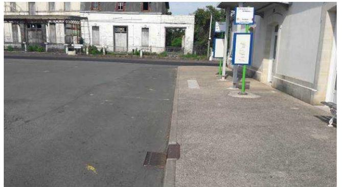
arrêt de bus sans quai surélevé pour faciliter l'embarquement, bande podotactile usée, absence de guide tactile vers celle-ci
